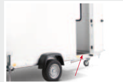
Barrierefreie Einstiegstür ohne Stolperkante
